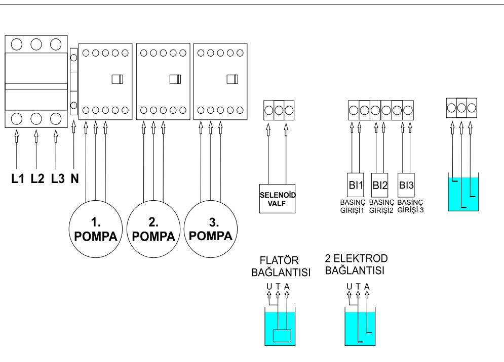
Sıvı seviye elektrodu veya flatör kullanılmıyorsa uçlarını köprüleyiniz. Selenoid valf ucunda 220V vardır köprülemeyiniz.
