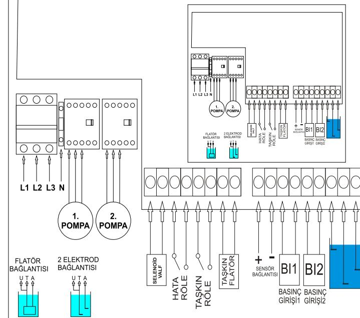
Sıvı seviye elektrodu veya flatör kullanılmıyorsa uçlarını köprüleyiniz. Selenoid valf ucunda 220V vardır köprülemeyiniz.
