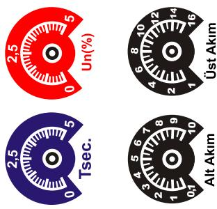
Panonun tüm ayarları ön panel arkasında bulunan potans düğmeleri ile yapılır. Potans düğmelerinin görünüşü yan tarafta verilmiştir. Potans düğmelerinin kullanımı ve panonun ayarlanması şu şekildedir ;
