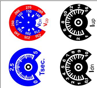
Panonun tüm ayarları ön panel arkasında bulunan potans düğmeleri ile yapılır. Potans düğmelerinin görünüşü yan tarafta verilmiştir. Potans düğmelerinin kullanımı ve panonun ayarlanması şu şekildedir ;
